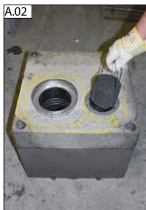
Vložte spodní díl (2) pro přívod vzduchu do šachty.
