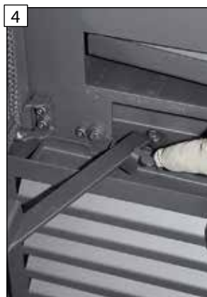
4 Aretace dvířek topeniště. Zajišťuje, že dvířka jsou trvale otevřená za účelem čištění spalovací komory.
