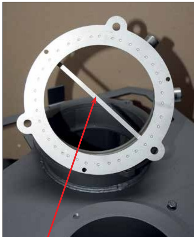
Pohled na bariéru integrovanou do přechodu spojovacího vedení.
