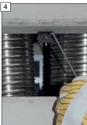
Odšroubujte zajišťovací šroub mřížky konvekčního vzduchu.
