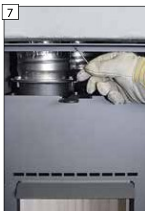
7 Pomocí inbusového klíče zcela vyšroubujte všechny upevňovací šrouby na rámu topeniště.
